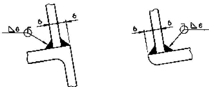
**СОЕДИНЕНИЕ ФЛАНЦА ЛЮКА/МОНТАЖНОГО ПРОЕМА
