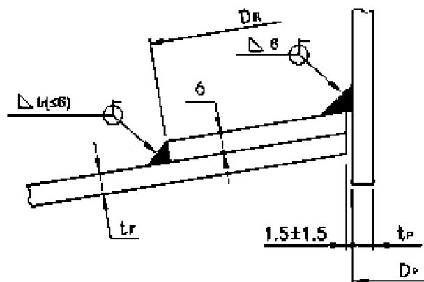
**СОЕДИНЕНИЕ СТЕНКИ МОНТАЖНОГО ПРОЕМА
