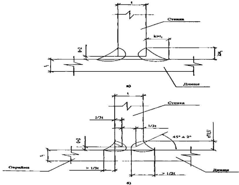
$t$  – толщина стенки;  $t_1$  – толщина окрайки;  $k$  – величина катета шва.
