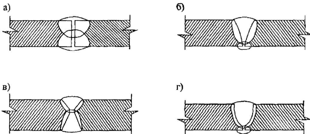
а) без разделки кромок; б) со скосом двух кромок; в) с двумя скосами кромок;
