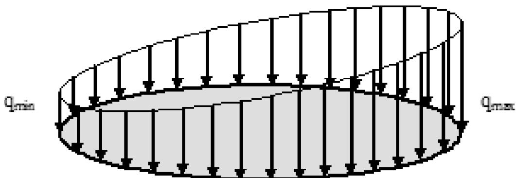
5.4.7. Расчетная вертикальная нагрузка  $Q_{max}$ , МН на фундамент резервуара, соответствующая расчетному сочетанию нагрузок 1 (см. таблицу 19), составляет:
