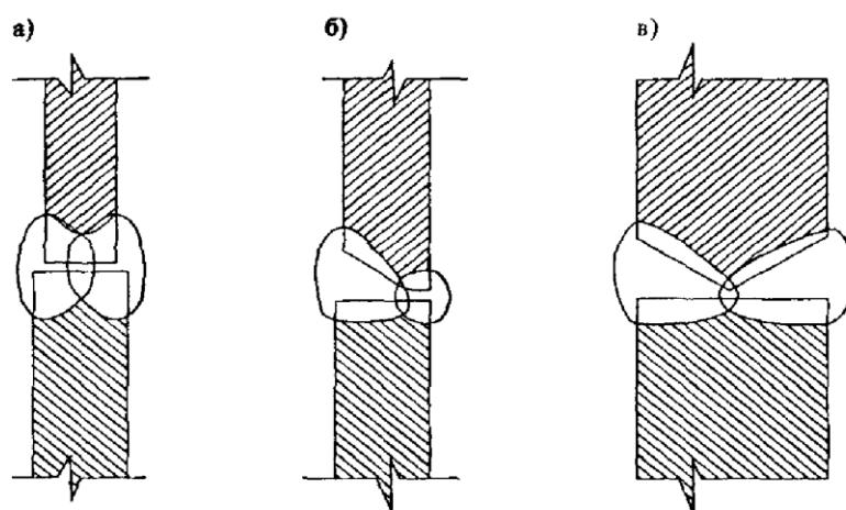
а) без разделки кромок; б) с криволинейным скосом одной кромки верхнего листа;
