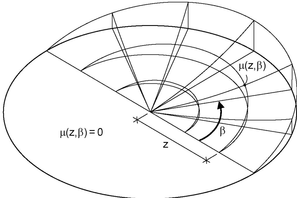
"Рис. 8. Неравномерное распределение снежной нагрузки на стационарной крыше"
